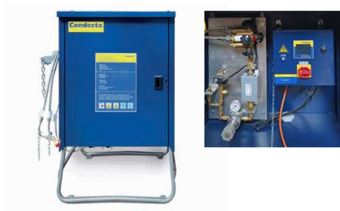
Der GSA-Steuerschrank besteht aus einem Bauverteilerkasten, in welchem die Steuerung und die Gasversorgung untergebracht sind. An dem GSA-Steuerschrank können zwei Einzelflaschen befestigt werden. Die Gasreserve-Umschaltung erfolgt von Hand. Die pH-Messung dosiert automatisch die notwendige CO<sub>2</sub>-Menge zum Erreichen des korrekten pH-Wertes im Auslauf der Anlage. Eine Blinkleuchte am Steuerschrank signalisiert einen zu hohen pH-Wert.
